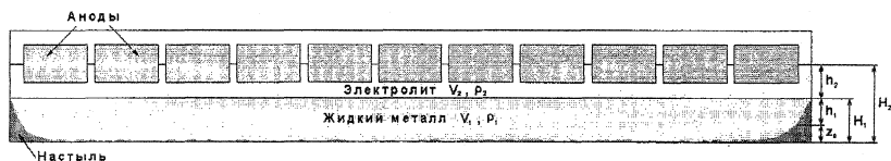
Рис.2б. Электролизная ванна, вид сбоку
