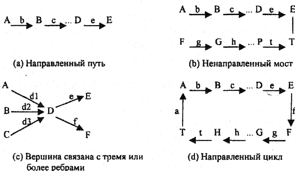
Рис. 4 Основные конструкции графа объектно-ориентированного WHERE предиката
